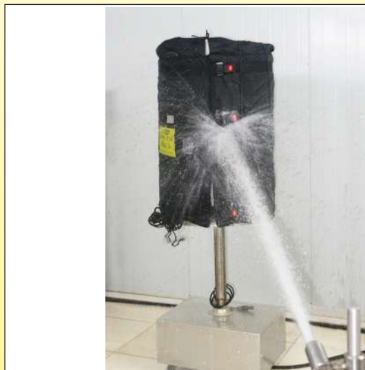
Test IPx6 dei riscaldatori a mantello
