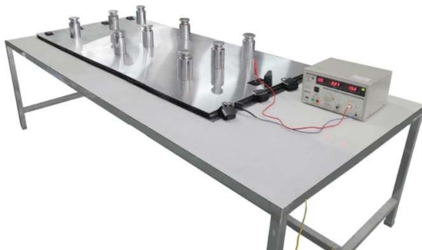
Apparecchiatura di misurazione per la dispersione di corrente totale a freddo
